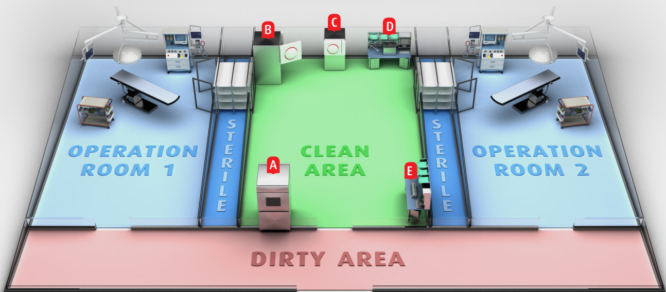
(A) Washer Disinfecter, (B) 5075HSG, (C) 3870HSG, (D) Steri-Center Packing Table, (E) Sealing Machine
